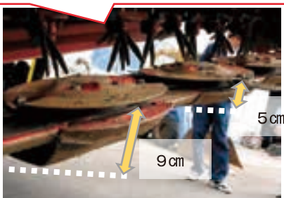
図3 オプションのソリ(左)を装着したものと通常の部品(右)の高さを比較
